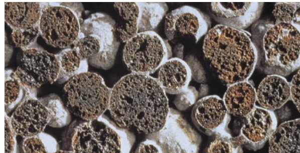
Rez keramikým LiaporBetonem - mezerovitá struktura
