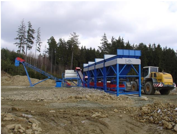
Míchací zařízení pro výrobu MZK, výkon linky 150 t/h, celkový příkon linky 80 kW
